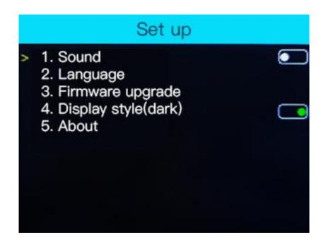
Über die Einstellungsoberfläche können Sie Sound, Sprache, Aktualisierung, Bildschirm einstellen. Verwenden Sie zur Auswahl die Tasten "UP" und "DOWN". Drücken Sie die Taste "OK", um die Parameter zu ändern. Drücken Sie die Taste "LINKS", um zu speichern und zu beenden.
