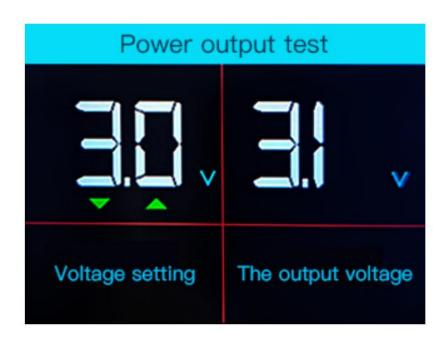
\* Die 0-5-V-Stromversorgungsfunktion ist nützlich, wenn Sie die Verkabelung zur ECU / ECM überprüfen. Nachdem Sie den Sensor mit einem Multimeter überprüft haben, können Sie bei weiterhin auftretenden Problemen die vom Sensor ausgegebene Spannung simulieren, um die Verkabelung zur ECU zu überprüfen.
