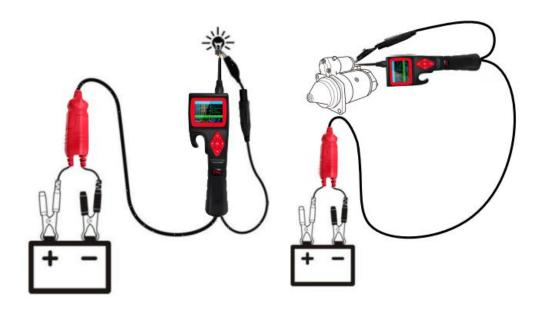
Wenn der Sondenschutzschalter ausgelöst hat, bedeutet dies, dass die Sonde überlastet ist. Dies kann folgende Gründe haben:
