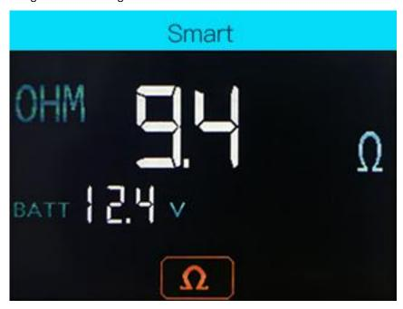
Wie in der Abbildung gezeigt: "BATT "bedeutet, dass die Batterieversorgungsspannung 9,9 V beträgt und "OHM "der aktuelle Testwiderstandswert von 0,0  $\,^\Omega$  ist.
