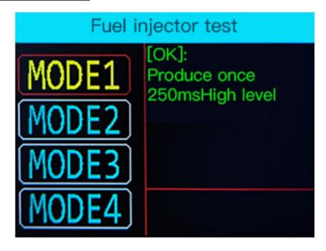
Die Sonde gibt verschiedene Impulssignale an den Injektor aus und überprüft den Sprühstatus des Injektors. Diese Funktion kann bei der Diagnose von Injektorzuständen helfen. Es kann mit jedem Kraftstoffdrucktester verwendet werden.
